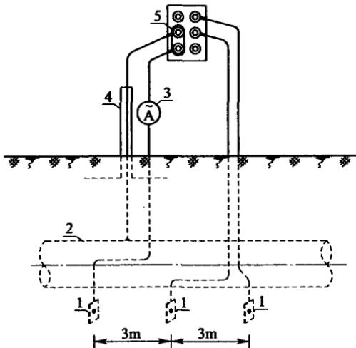
图A.3.2 交流电流密度测量接线图
