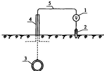
图 A.2.2 管道交流干扰电压测量接线图
